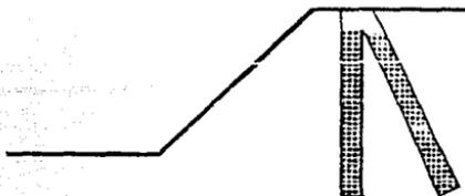
IV.3 PILOTES VERTICALES COLOCADOS EN SITIO UNIDOS A PILOTES INCLINADOS O A MUERTOS DE ANCLAJE.
