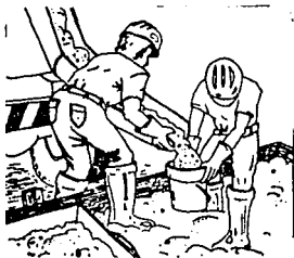
FIG III.20 MUESTREO DE CONCRETO FRESCO
