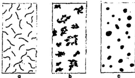
FIG.1.3.7. Formas de grafito en las fundiciones de hierro: a) Laminar b) en forma de rosetas c) nódulos.
