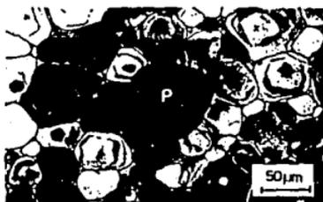
Figura 27. Aleación 96Mo-4Ni que fué sinterizada, la microestructura rodea a un poro (P).
