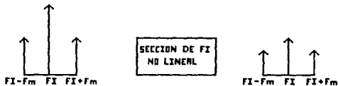
Figura 3.15. Modificación de las características de amplitud de una señal de FM al pasar a través de una sección de FI no lineal.
