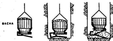
FIGURA U1.7 FUNCIONAMIENTO DE UNA BACHA
