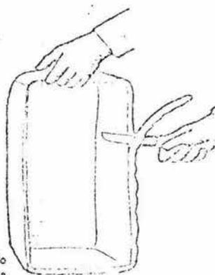
De preferencia, antes de desmoldar deje el molde en el modelo durante varias horas, o toda la noche, para que cure y alcance mayor dureza. Para desmoldar, utilíse de cuñas de madera o, mejor aún, de cuñas de polietileno o teflón.
