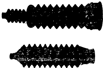
FIG.42 Cubrepolvo protector del conjunto engrane piñón de la dirección.
