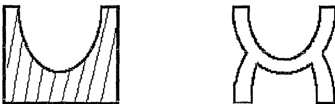
Figura 5.1. Trazado de una pieza de gran masa aplicando un diseño de espesores constantes.
