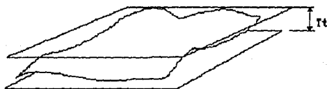
figura 2.12. Tolerancia de planitud total
