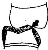
Falta del biselado (provoca perforación al metal).
