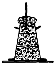
LLENO DE CONCRETO, 25 GOLPES EN LA 3 a CAPA
