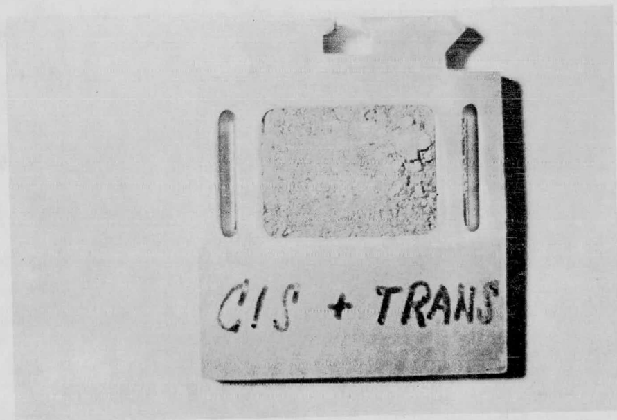
Fig.9b) Superficie resultante (el tamaño de partícula es grande)
