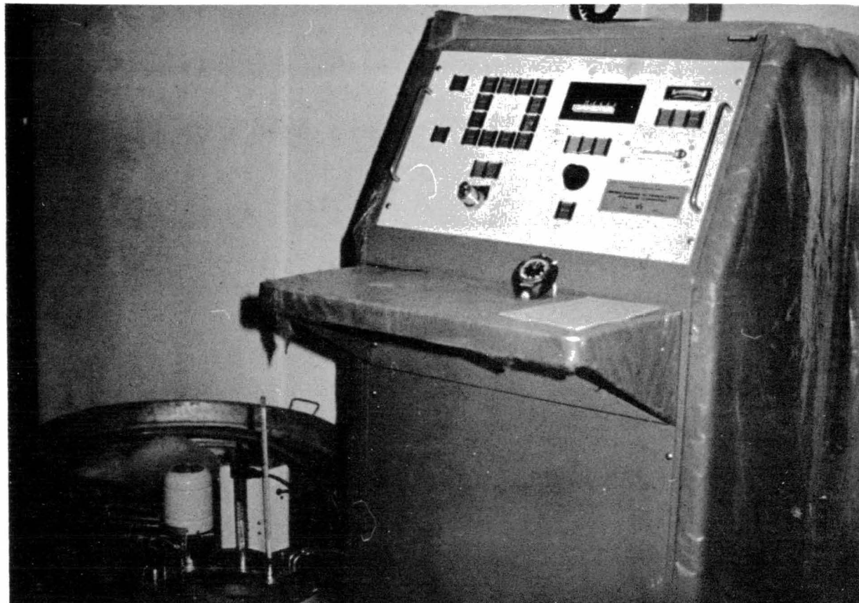
Figura 1. Consola de mandos de la Unidad Gamma-beam-650 y dispositivo para temperatura atenuada.
