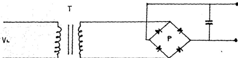
Esta consta de un transformador de potencia cuatro diodos que son un puente de onda completa con un capacitor que funciona como filtro.
