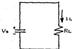
Calculando la carga de un capacitor cuando se esta descargando.
