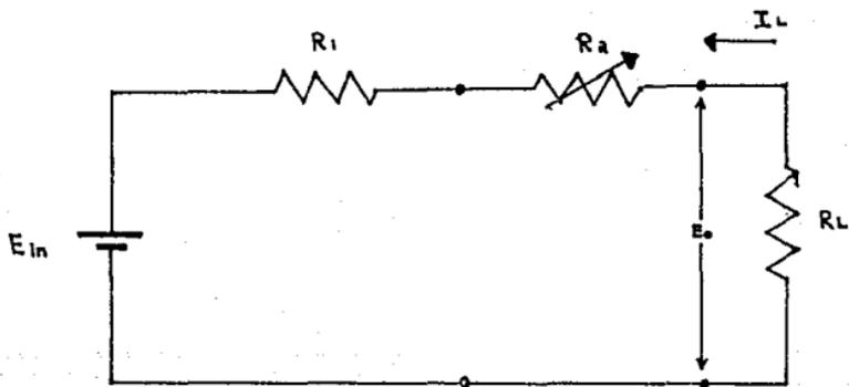
En la  $R_1$  representa la resistencia interna de la alimentación e  $I_L$  es la corriente consumida por una carga variable  $R_L$ . Si  $I_L$  disminuyese debido a un aumento en  $R_L$ .
