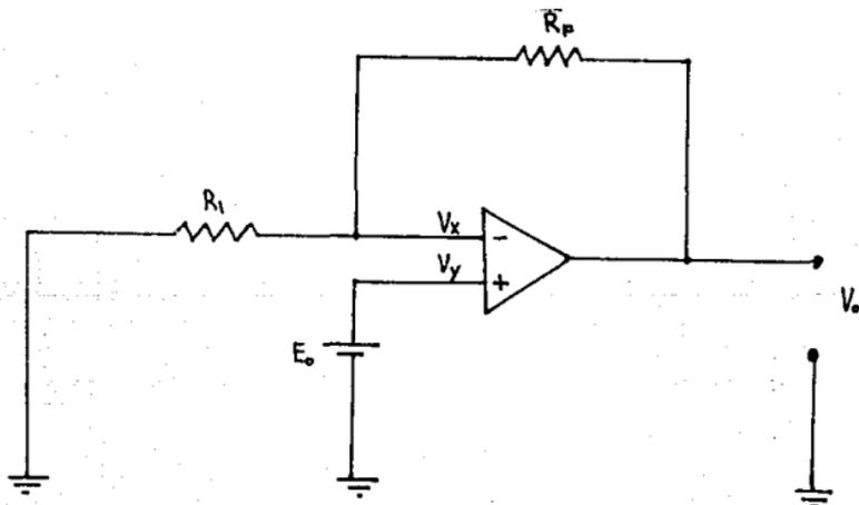
Las características de los amplificadores operacionales son las siguientes :Ganancia  $A_v = \alpha$ , Impedancia de entrada  $Z_i = \alpha$ , Impedancia de salida  $Z_o = 0$ , Ancho de banda  $BW \rightarrow \alpha$ , Tiempo de respuesta  $T_r = 0$ .
