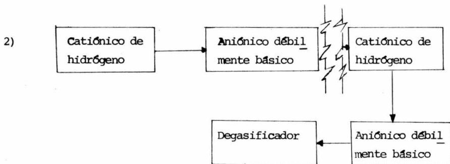
Fig 6.10 Deionización convencional sin remoción de sílice
