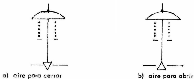
Fig. 39 Posición de las válvulas a falla de aire.
