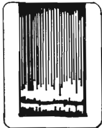
INTERFERENCIA CAUSADA POR BURBUJAS DE AIRE - EN EL ORIFICIO
