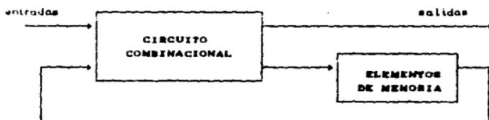
Figura 2.1. Diagrama de bloque de un circuito secuencial
