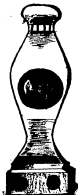
Fig. 1 Sistema de lámpara espejo y vela, usado en el cistoscopio de Bossini.
