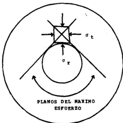
Figura V.2 Planos del máximo esfuerzo cortante.
