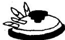
COLECTOR CON ENTRADAS DE LECHE EN FORMA ANGULAR (DISPOSICION CLASICA) VISTA SUPERIOR
