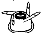
COLECTOR CON ENTRADAS DE LECHE EN FORMA TANGENCIAL (FLUJO DE ESTRELLA) VISTA SUPERIOR
