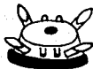
COLECTOR CON ENTRADAS DE LECHE EN FORMA ANGULAR (DISPOSICION CLASICA) VISTA SUPERIOR
