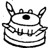
COLECTOR CON ENTRADAS DE LECHE EN FORMA ANGULAR (DISPOSICION CLASICA) VISTA SUPERIOR
