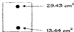
Fig 2.30.- Cantidades de acero de diseño de la viga B28 (extremo izquierdo, nivel 2)
