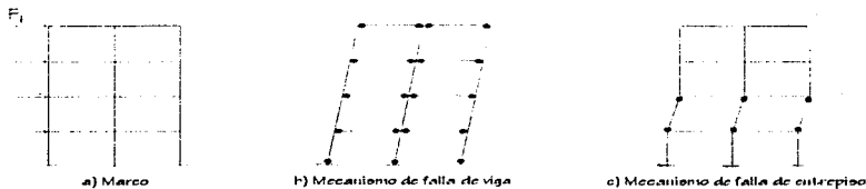
Fig 1.12.- Mecanismos de falla
