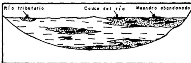
CORTE TRANSVERSAL DONDE SE MUESTRA LOS DEPOSITOS DE RELLENO DE CANAL Y BARRAS DE MEDIA LUNA
