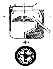
Fig. 4 Caldera empleada en la fabricación del yeso.
