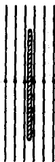
Fig. 4. Patrón del campo exterior para un alambre paralelo al campo aplicado (Ref. 18).
