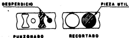
Ilustrando la diferencia entre las operaciones de punzonado y recortado.
