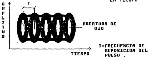
La interferencia debida a la distorsión de la forma de onda ( que depende de la limitación en la banda de frecuencia de transmisión ) es llamada INTERFERENCIA INTERSIMBOLO. La magnitud de esta interferencia y la degradación en el nivel puede ser observada y checada simplemente con un PATRON DE OJO o DIAGRAMA DE OJO, por combinación de todos los patrones de pulsos posibles.
