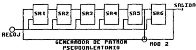
fig. 11.17.- MEDICION DEL BIT DE ERROR Y GENERADOR DE PATRON PSEUDOALEATORIO.
