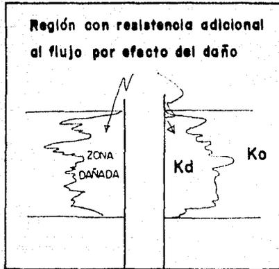
FIG. 1.7.2. Efecto de daño a la formación.
