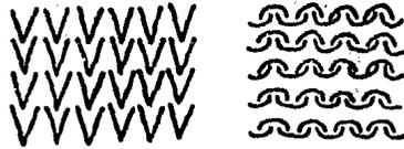
Fig.5 Aspecto general del tejido de punto más sencillo a una sola cara. A la izquierda, como se ve por el haz (derecho técnico), y a la derecha como se ve por el envés (revés técnico).
