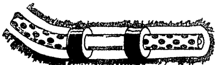
22.- TERMINACION CON T.C. RANURADA Y EMPACADOR DE TUBERIA PARA EL AISLAMIENTO DE ZONAS INTERMEDIAS QUE PRODUCEN AGUA (17)
