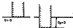
Fig. 28c. Influencia de la profundidad de desplante en el valor de N_c , en suelos puramente cohesivos
