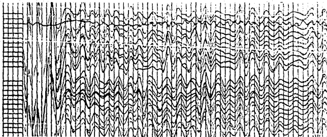
Fig. I.11.- El grupo conectado a la traza número tres puede estar desconectado, ó éste puede estar abierto ó en corto circuito en el cable de conexión ó en los instrumentos.
