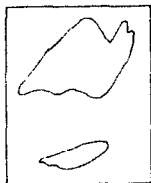
FIG 5.3 FRICCIÓN EXCESIVA EN EL SISTEMA DE BOMBEO*
