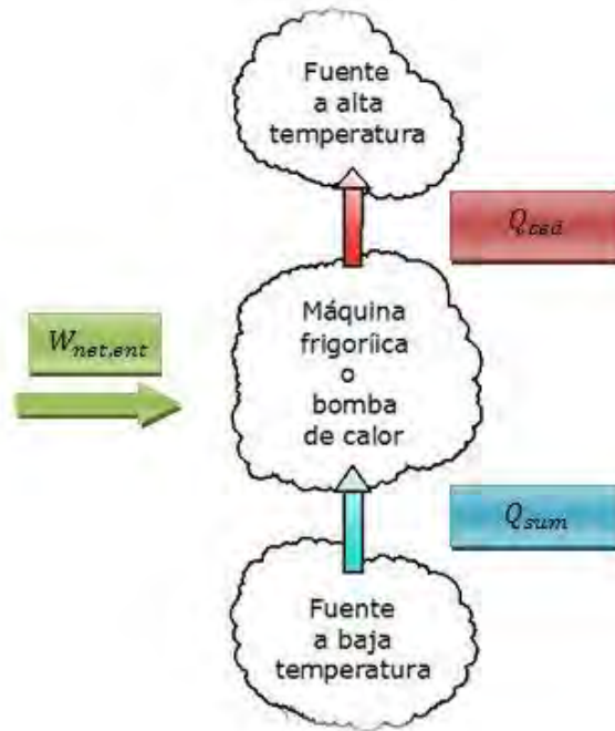
Figura 1: Esquema simple de una máquina frigorífica o bomba de calor [17].
