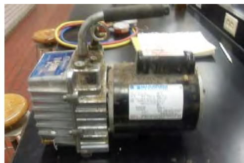
Figura 14: Bomba de vacío de \frac{1}{2} [HP].
