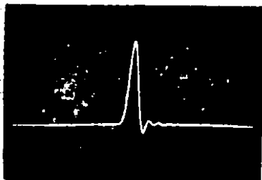
FIG.41 PULSO ST ENHIBIENDO DISTORSION GANANCIA/FRECUENCIA Y/O GRUPO DE DISTORSION DE RETARDO
