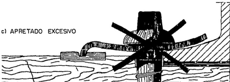
GRAPA ELASTICA "R.N." Esta pieza está formada por dos secciones de solera y un bucle, siendo de acero de alta calidad (cromo-manganeso), la cual produce una presión elevada y uniforme (a) sobre el patín del riel y además, sirve como tope lateral (b) para evitar en cierta medida, la fricción que se produce entre el patín del riel y la placa de hule (s), transmitiendo estos esfuerzos laterales hacia el durmiente por medio del bucle, evitando molestar el perno de sujeción.
