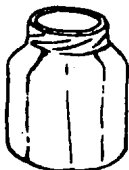
Figura 24. El FRASCO GERBER DE BOCA ANCHA ofrece múltiples ventajas cuando es empleado en micropropagación, pudiéndose mencionar entre otras las siguientes: Soporta muy bien la presión y temperatura de esterilización en autoclave.
