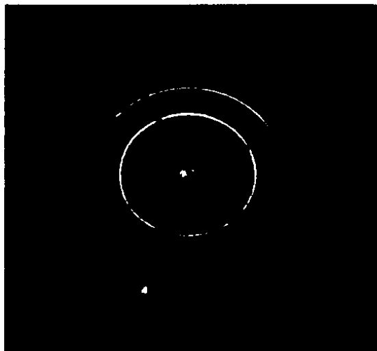
Figura 2.1b. Interferograma de comparación obtenido usando una lámpara de descarga que contiene hidrógeno.
