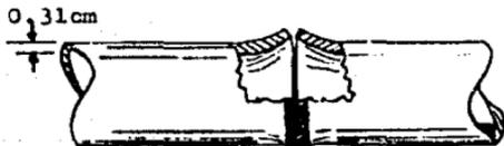
Unión a tope para tubería con menos de 0.31 cm de espesor de pared.
