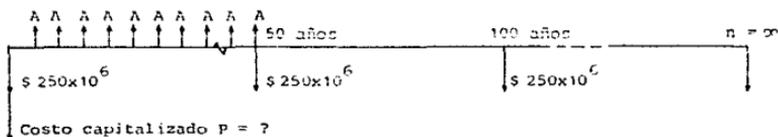
Figura 3.4. Diagrama de flujo de caja para el ejemplo 3.6.
