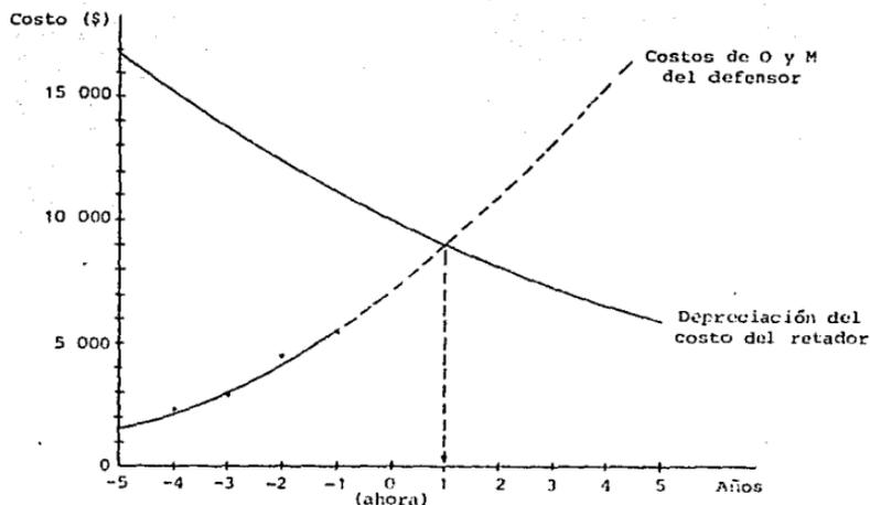
Figura 5.4. Año en el que debe realizarse el reemplazo para el ejemplo 5.15.
