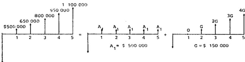
Figura 2.20. Diagrama de flujo de caja para el ejemplo 2.13.
