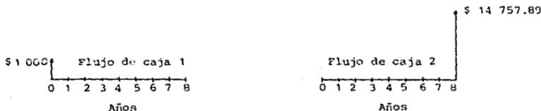
Figura 2.22. Dos flujos de caja equivalentes al 40%.
