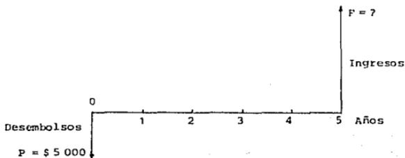
Figura 2.5. Diagrama de flujo de caja para el ejemplo 2.1.
