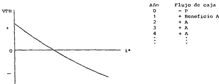
Figura 3.8. Gráfica típica del VPN para una inversión.
