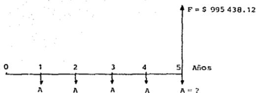
Figura 2.10. Diagrama de flujo de caja para el ejemplo 2.6
