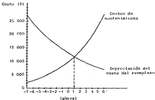
Figura 5.7. Año en que debe realizarse el reemplazo para el ejemplo 5.16.
