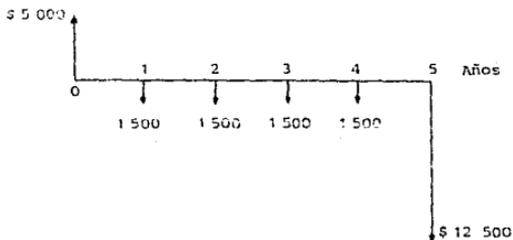
Figura 2.2. Diagrama de flujo de caja del plan 2 de la tabla 2.1. (Prestatario).
