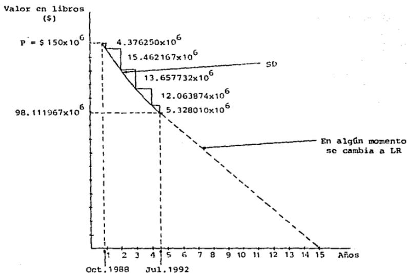
Figura 4.12. Depreciación por recuperación acelerada del costo. (Bienes raíces).
