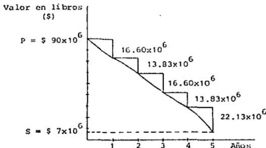
Figura 4.14. Depreciación por unidad de producción.
