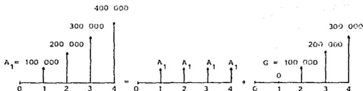
Figura 2.17. Diagrama de flujo de caja para el ejemplo 2.11.
