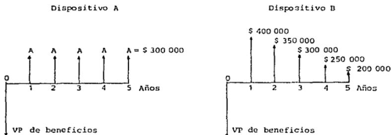
Figura 3.2. Diagramas de flujo de caja de las alternativas del ejemplo 3.1.
