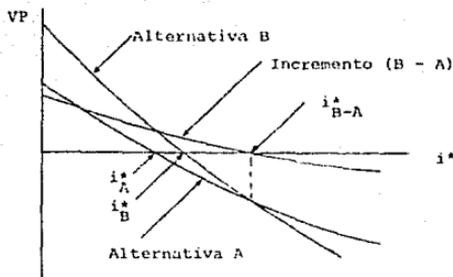
Figura 3.10. La función de valor presente para un incremento en la inversión.
