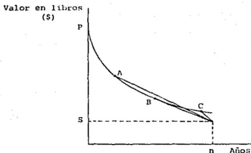
Figura 4.9. Tres puntos posibles en los que se puede cambiar de saldo decreciente a depreciación en línea recta.
