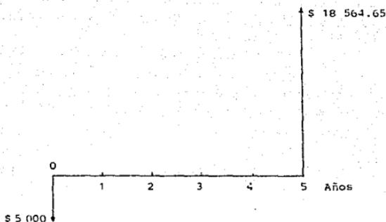
Figura 2.3. Diagrama de flujo de caja para el plan de la tabla 2.2. (Prestamista).
