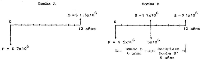
Figura 3.6. Diagramas de flujo de caja para el ejemplo 3.12.
