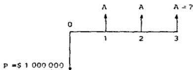
Figura 2.12. Diagrama de flujo de caja para el ejemplo 2.7.
