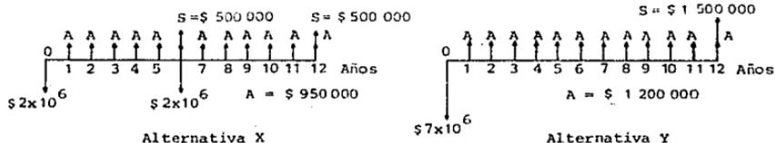
Figura 3.11. Diagramas de flujo de caja para las alternativas del ejemplo 3.19.
