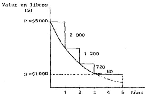
Figura 4.7. Terminación de la depreciación por saldo doble decreciente cuando se alcanza el valor de salvamento estimado.
