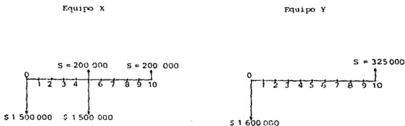
Figura 3.3. Diagramas de flujo de caja de las alternativas del ejemplo 3.4.
