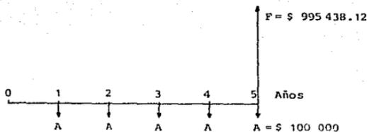
Figura 2.9. Diagrama de flujo de caja para el ejemplo 2.5.
