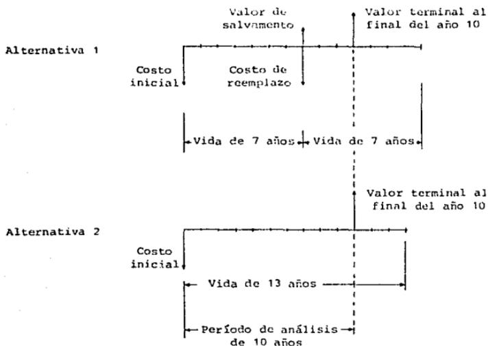
Figura 3.1. Superposición de un período de análisis para las alternativas de 7 y 13 años.
