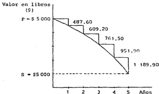
Figura 4.13. Depreciación por fondo de amortización.
