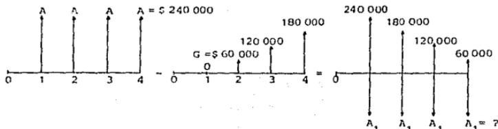
Figura 2.18. Diagrama de flujo de caja para el ejemplo 2.12.
