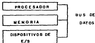
FIG 2.2 ARQUITECTURA GENERAL DE UNA MICROCOMPUTADORA
