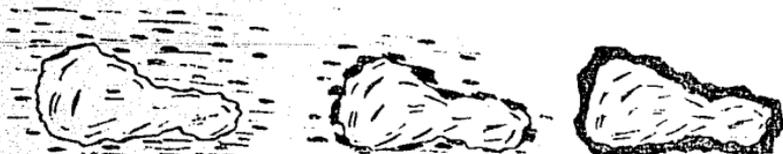
Pasos por los que atraviesa una emulsión hasta tener la ruptura completa - ante un material pétreo.
