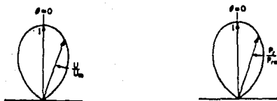
FIG. 8. Patrones de intensidad de radiación y potencia relativos.
