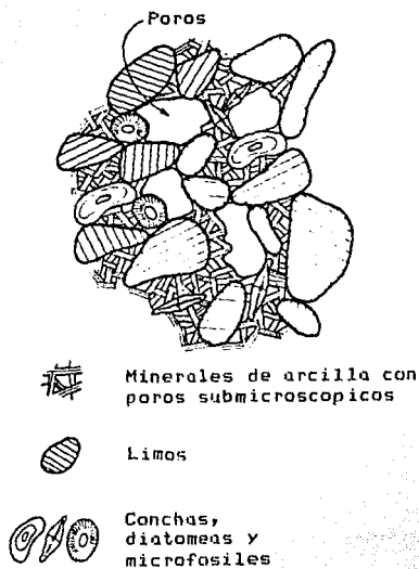
Fig. 3.4 Descripción esquemática de la arcilla del Valle de México (Zeevaert, 1973)
