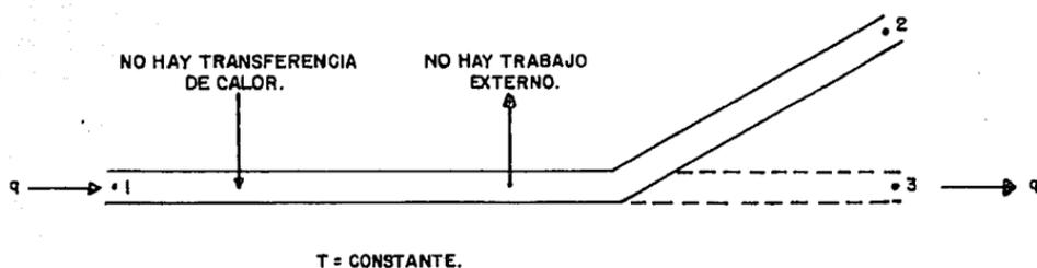
**FIG.4.1 FLUJO ISOTERMICO DE GAS POR TUBERIAS.**
