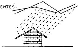
**TEMPERATURA.-** LA TEMPERATURA EN TEPOZTLÁN OSCILA ENTRE 34/35°C A LA MÁXIMA Y 7,5°C A LA MÍNIMA POR LO QUE SE RECOMIENDA TENER ZONAS CUBIERTAS CON VOLADOS, PARA ÉPOCA DE VERANO Y PARA ÉPOCA DE INVIERNO ZONAS PERGOLADAS PARA CAPTAR LA ENERGÍA SOLAR. SE RECOMIENDA USAR MATERIALES TÉRMICOS (ARCILLAS)
