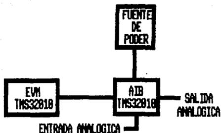
Fig 5.2 Configuración del Sistema Emulador/AIB
