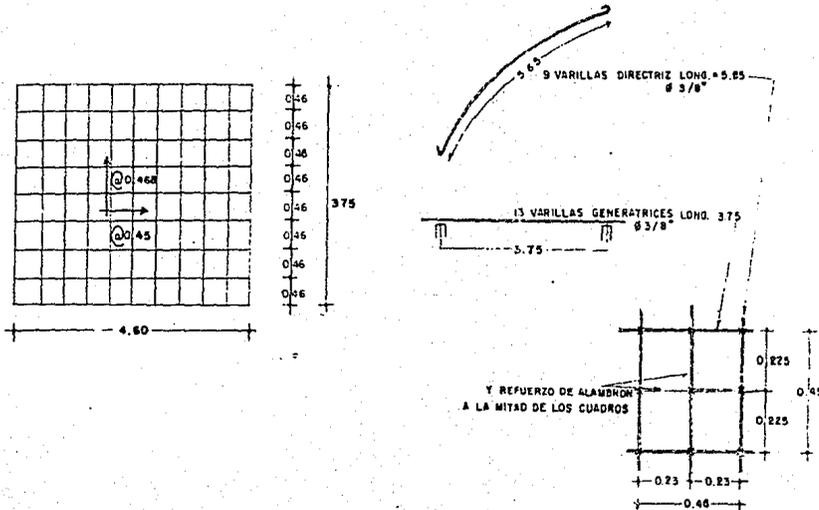
Obteniendo con esto un armado ortogonal de cuadros de 0.225 x 0.234 ( $\pm$  0.25 limite especificado por - colado), ya que lo que se busca es un concreto -- armado con ésta sección:
