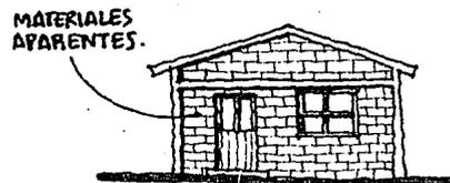
Los muros de las zonas más céntricas tienen secciones anchas de 30, 40 ó 45 cm., mientras que actualmente no rebazan los 15 cms., la diferencia se debe al cambio en los materiales con que se construye y a la distinta estructuración de los edificios.
