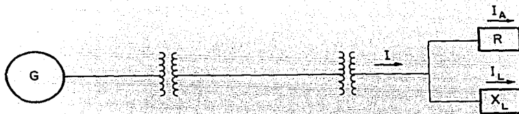
Fig II.2. Esquema de alimentación eléctrica de una planta industrial.
